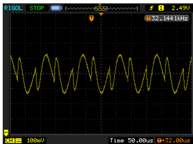
Напряжение на выводе 6 ОУ U8 (усиленный остаточный разбаланс датчика).
